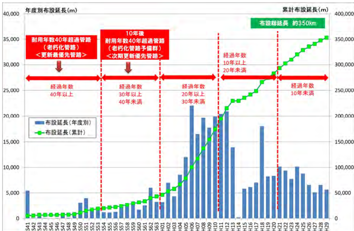
図-3.2(4) 配水管（75mm 以上）における布設年度別管路延長・布設総延長
