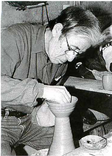
唐津焼の土に立石の土を混ぜた陶土をロク口で成形する松尾さん
