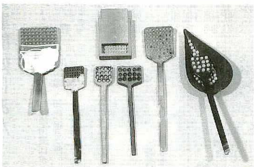
薬袋一袋分の数の穴があいた計数匙（中富記念くすり博物館収蔵）
