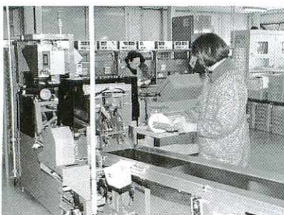
導入された自動選別機(奥)と自動計量結束機
